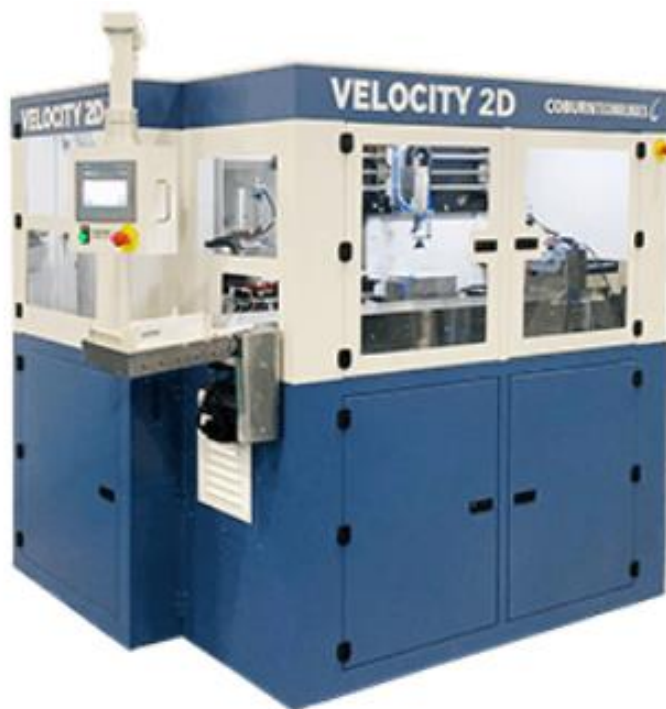
1.13-сурет – Velocity 2D линзаларға жабын жабу қондырғысы
